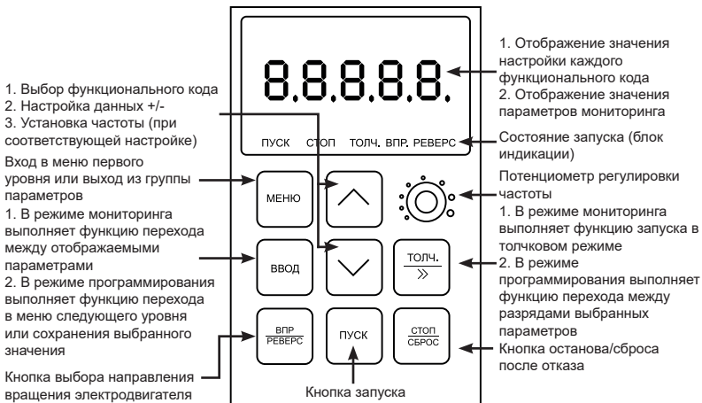
Рисунок 6 – Описание панели управления LCI-KP-S
