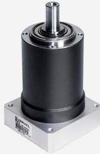
La serie dei riduttori epicicloidali a gioco ridotto tipo RG, costruita con carcassa monolitica in acciaio da bonifica sulla quale è ricavata mediante brocciatura la corona dentata interna, può alloggiare 1 o 2 stadi di riduzione.
